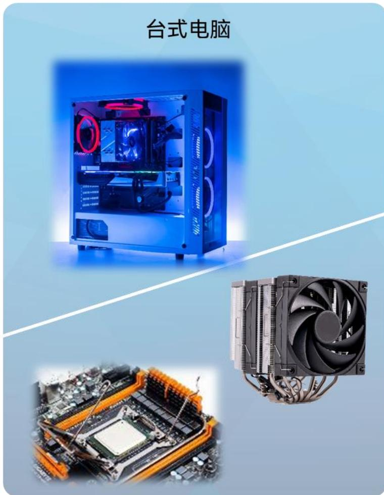
高功耗CPU采用冷却塔进行散热
