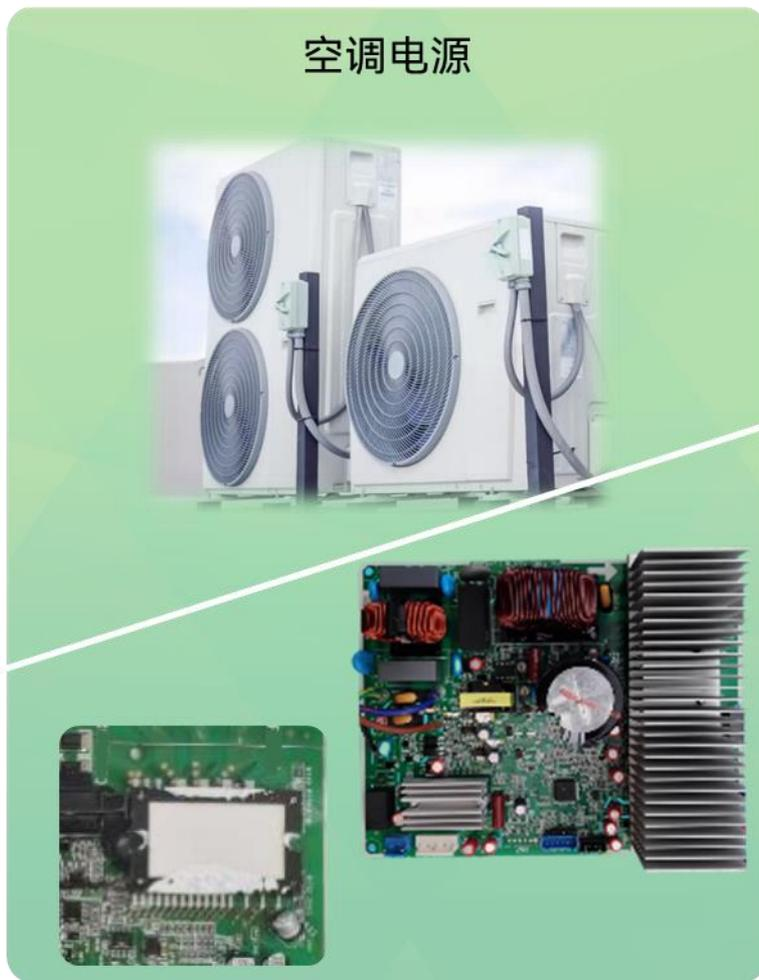
空调逆变器IPM模块采用铝合金散热器
